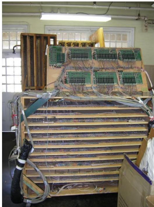
*Figure 10 Devtronix Organ Relay*
